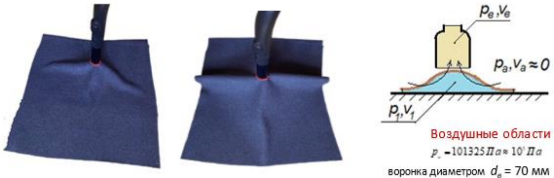
Рисунок 14 – Захват лоскута с гладкой поверхности. Образование флейт
