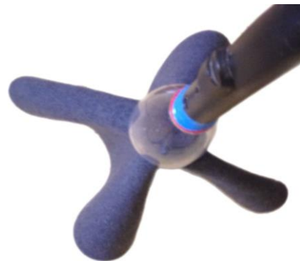
Рисунок 6 – Статистика многосекторных форм изгиба круглого лоскута (а); 4-секторный конус в эксперименте (б).
